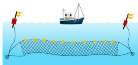
Figure 3 : filet droit constitué d'une nappe unique (Source : SMEL)
