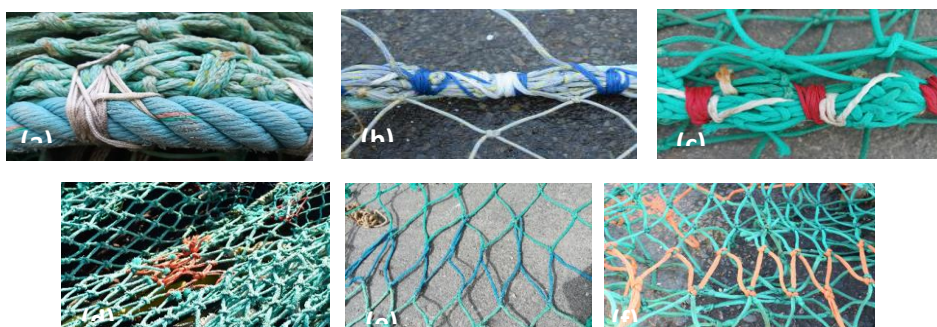
Figure 26 : Différentes tresses et ficelles utilisées pour la réparation et le montage des chaluts ( source : SMEL)
