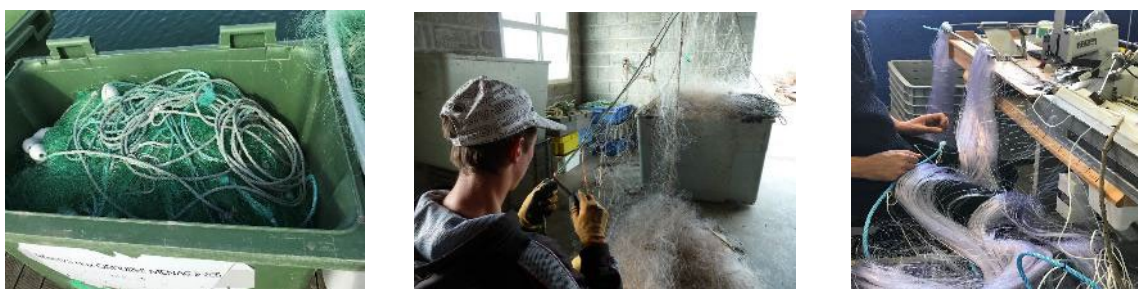
Figure 34 : Gestion des filets fins usagés sur le port de la Cotinière – de la collecte (à gauche) au remontage (à droite) en passant par le démontage des cordages (centre) (Source : rapport PECHPROPRE)
