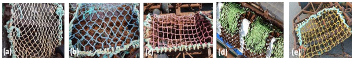
Figure 27 : Plastiques des nappes de dragues anglaises : PA (a) et PEHD (b à e). (Source : SMEL)
